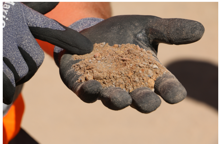
Foto: Mischabbruchgranulat für die Herstellung des ressourcenschonenden Zements Susteno
