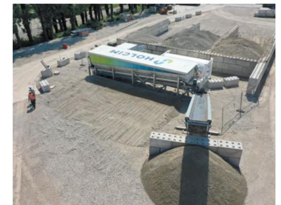
Grâce à cette installation mobile, basée sur la technologie neustark, nous stockons durablement chaque année environ 500 tonnes de CO<sub>2</sub> dans des granulats de béton.
