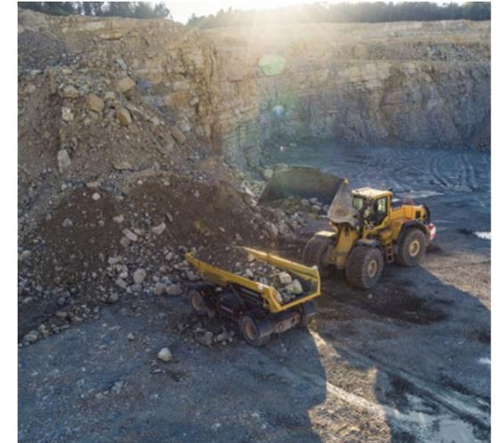
Chargement d'un dumper électrique autonome dans la carrière du Gabenchopf.
