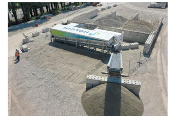
Mit dieser mobilen Anlage, basierend auf der neustark-Technologie, speichern wir jährlich rund 500 Tonnen CO<sub>2</sub> dauerhaft in Betongranulat.
