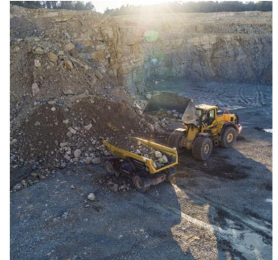
Beladen eines autonomen elektrischen Dumpers im Steinbruch.
