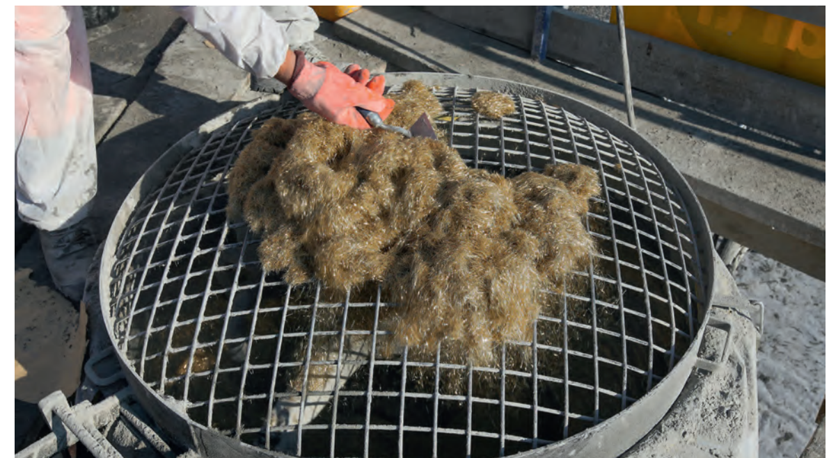
Die hohe Dosierung von Stahlfasern erhöht das Verformungsverhalten und macht Ductal® sehr duktil.
