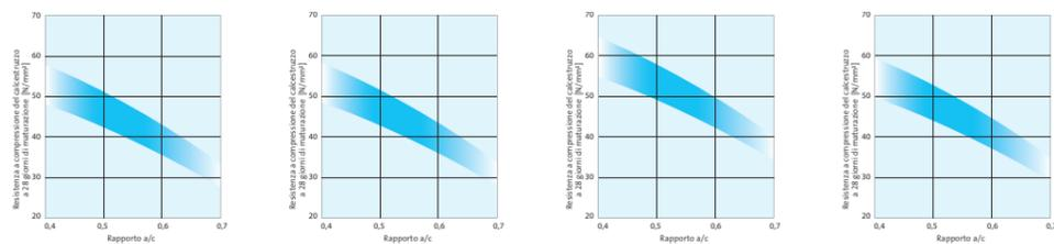
Valori indicativi per lo sviluppo della resistenza di calcestruzzo in base al tipo di cemento e alla temperatura di stoccaggio.
