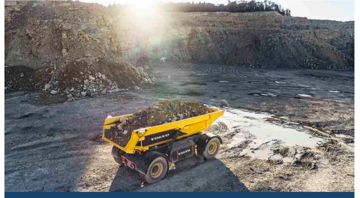
Der Dumper fährt los – batteriebetrieben und autonom.
