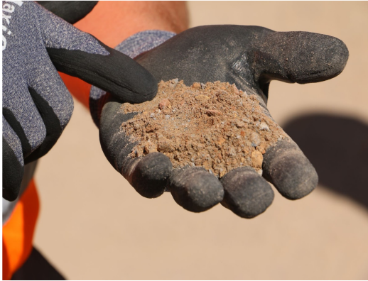
Mischabbruchgranulat für die Herstellung des ressourcenschonenden Zements Susteno.
